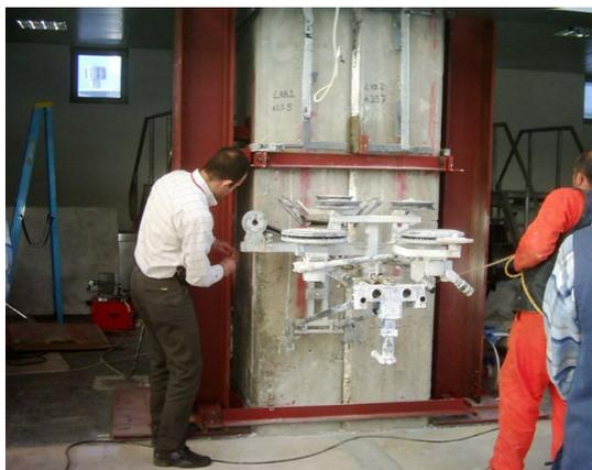
Figura 11 – Taglio dei pilastri con sega a filo diamantato
